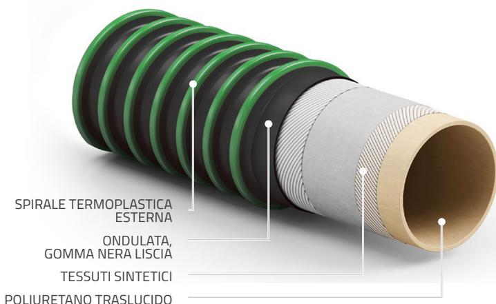
Tubo leggero e flessibile per camion cisterna per il trasporto di prodotti alimentari secchi, polverosi e costituiti da granuli. Prodotto in conformità alla GMP (Reg. (CE) 2023/2006).
