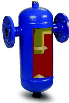
I separatori di vapore, come indicato già dal loro nome, separano il vapore dalla condensa trattenuta, o "asciugano" il vapore. Sono spesso utilizzati davanti ad attrezzature che richiedono un vapore particolarmente secco come ad esempio presse piane o autoclavi. Sono comuni anche sulle linee di vapore secondarie dove la condensa è stata raccolta e trasformata in vapore a bassa temperatura. Il vapore istantaneo per natura contiene un'alta quantità di condensa trattenuta.
