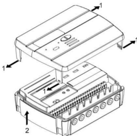
Rimuovere la staffa di fissaggio alla base dell'unità di calcolo e fissarla alla parete. Sono previsti due tipi di fissaggio a muro:
