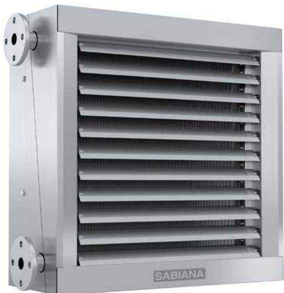
Gli aerotermini **Aix Sabiana** sono realizzati con struttura in acciaio inossidabile e batteria di scambio termico con tubi e attacchi flangiati in acciaio inossidabile e pacco alettato in alluminio. Sono disponibili in quattro grandezze per un totale di otto modelli. Questi apparecchi possono essere alimentati con acqua calda, surriscaldata e a vapore.
