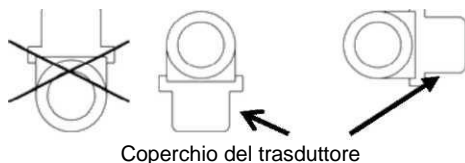
Fig. 4: Posizione di installazione raccomandata per le misurazioni di raffreddamento
