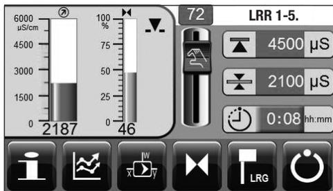
Usare il potenziometro manuale per modificare la posizione della valvola di blowdown continuo. Il pulsante verde indica l'apertura della valvola in %. oppure premere il pulsante verde e inserire il valore desiderato in % tramite la pulsantiera.
