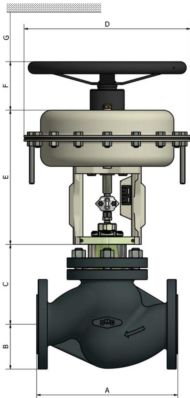
\* In accordo alla norma EN1092-2 le flange DN65 PN16 in ghisa devono essere fornite con 4 fori. Possono essere fornite con 8 fori solo su specifica richiesta del committente.
