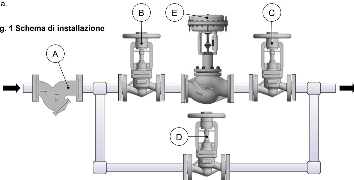
La posizione di montaggio della valvola non ne limita il funzionamento, tuttavia è consigliato montare la valvola con l'attuatore rivolto verso l'alto (pos. E Fig.1) in quanto altre posizioni potrebbero permettere l'accumolo di eventuali impurità presenti nel fluido danneggiando la valvola stessa.
