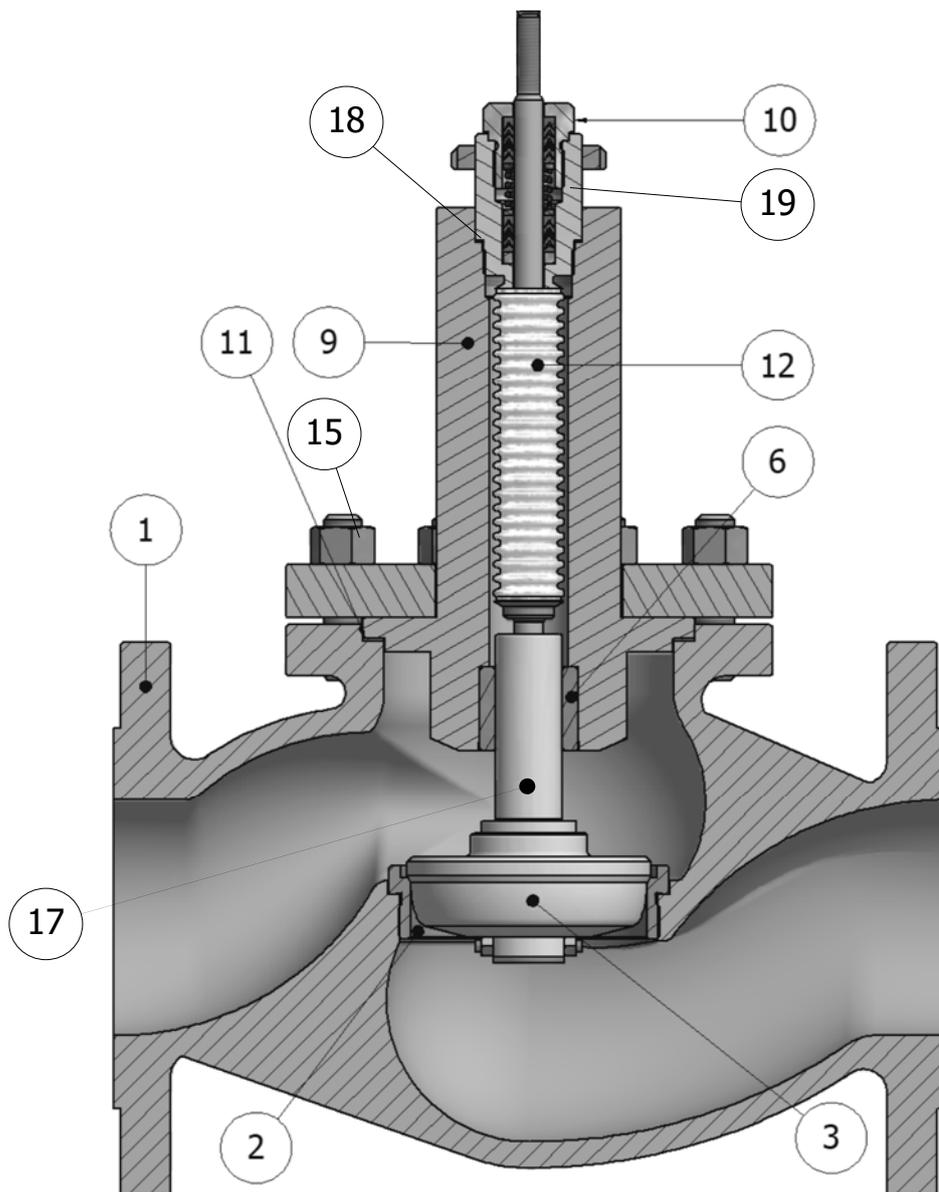
Fig. 10 Valvola con soffiETTO
