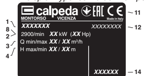
Beispiel Typenschild des Motors
