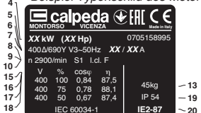
Beispiel Typenschild des Motors
